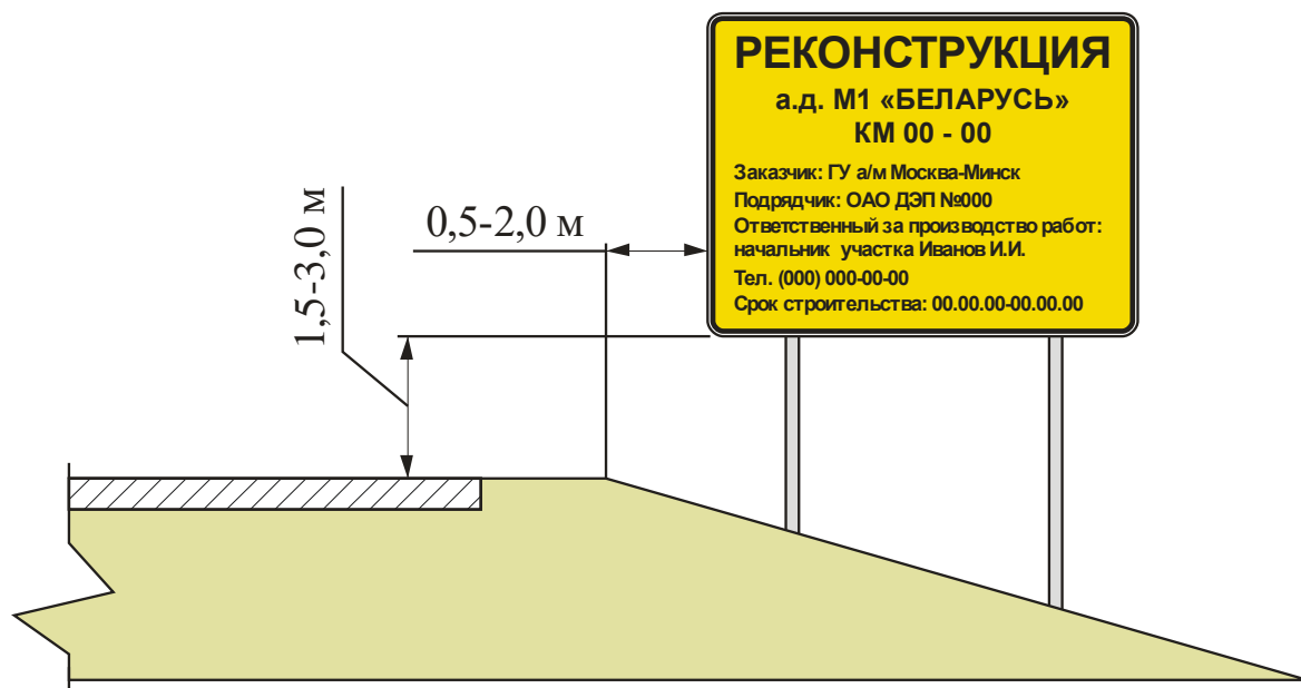
Рисунок В.2 – Пример размещения информационного щита относительно дороги
