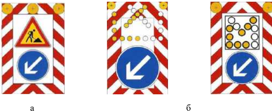
Рисунок 13 – Примеры передвижных заградительных знаков со световой индикацией: а ↑ без мигающей стрелы; б ↑ с мигающей стрелой
